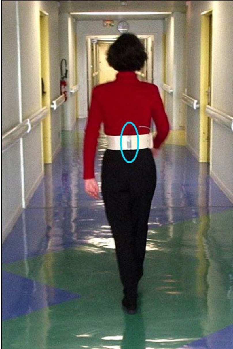
Fig. 1. Test de marche dans un couloir d'hôpital rectiligne ; le capteur, composé de deux accéléromètres, est appliqué en région médiane lombaire par une ceinture semi-élastique.
